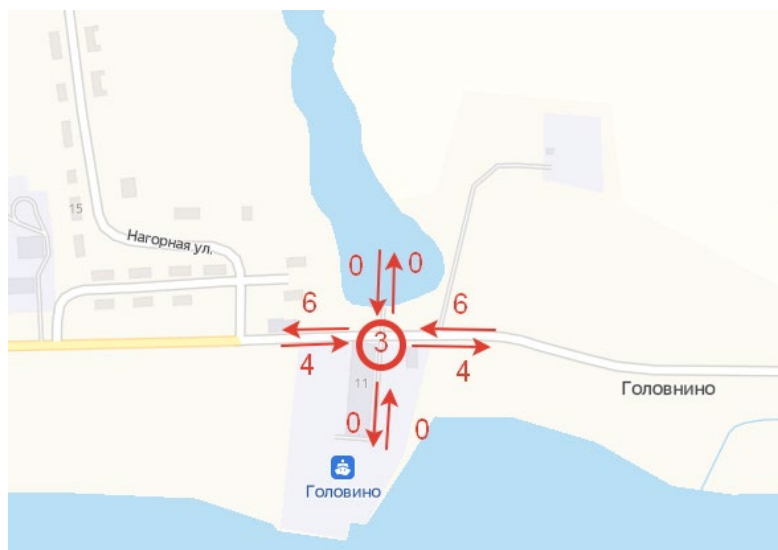
Рисунок 1.9.4 – Интенсивность движения на участках дорожной сети МО «Южно-Курильский городской округ» в утренний час «пик» для транспортного узла № 3
