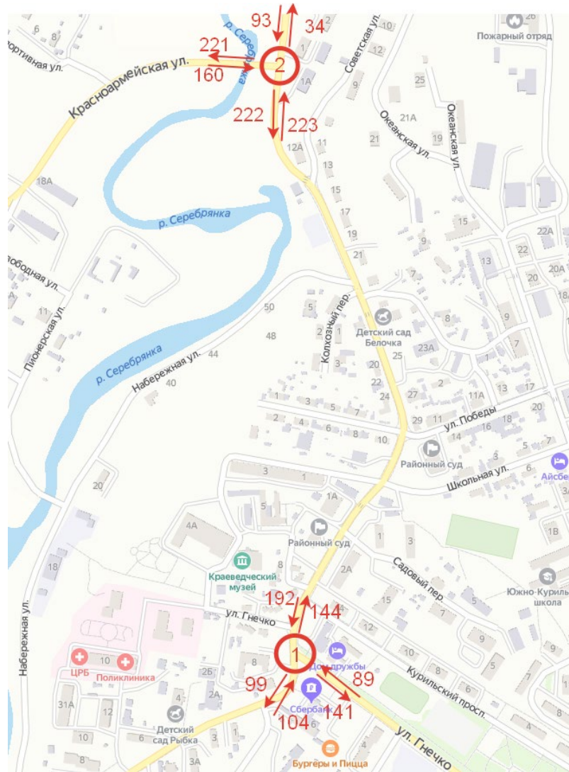
Рисунок 1.9.3 – Интенсивность движения на участках дорожной сети МО «Южно-Курильский городской округ» в утренний час «пик» для транспортных узлов № 1 и № 2
