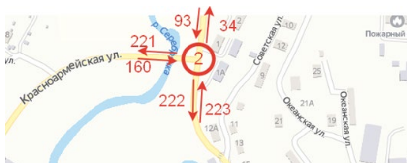
Рисунок 2.2.2 – Картограмма интенсивностей транспортных потоков на пересечении ул. Красноармейской и ул. Заречная в п.г.т. Южно-Курильск
