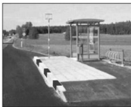
Рисунок 2.19.5 – Пример обустройства остановочного пункта пандусом
