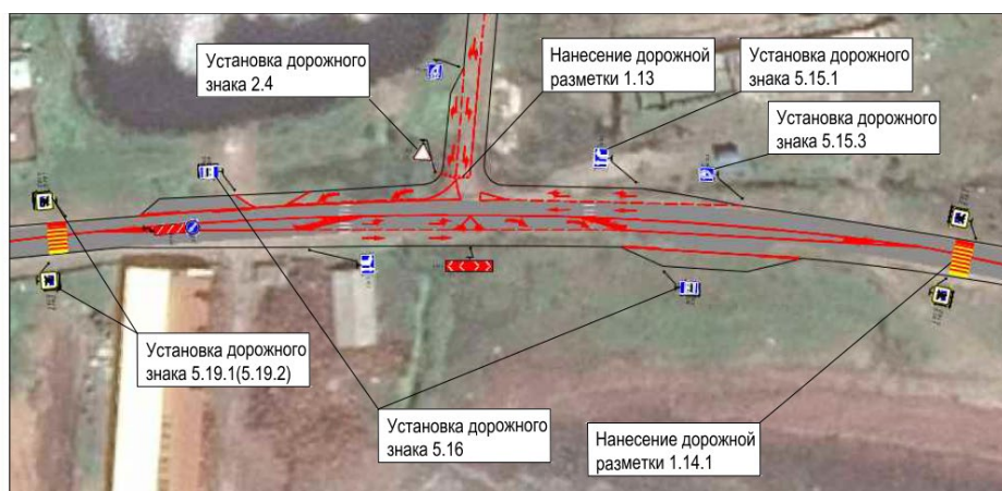
Рисунок 2.2.6 – Схема мероприятий ОДД на ул. Набережной, дороги к водохранилищу и порту
