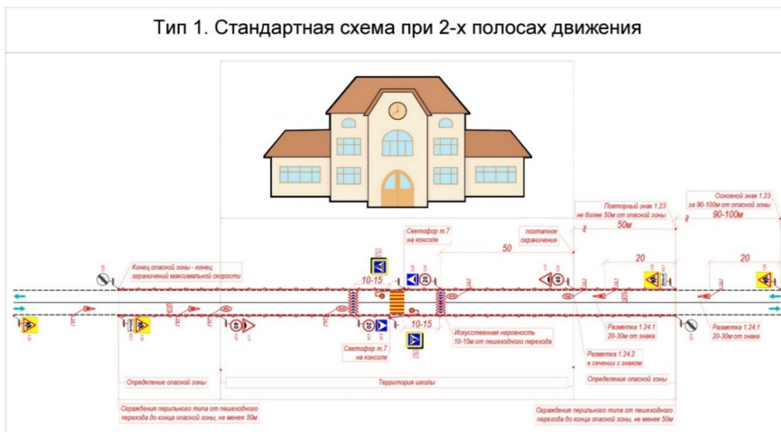
Рисунок 2.20.1 – Схема типового мероприятия по обеспечению БДД в районе детских учреждений при условиях «1+1» полосами для движения
